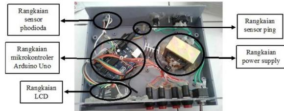
Gambar 11. Foto Rangkaian Elektronika Pembangun Set eksperimen
