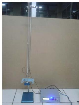
Gambar 15. Hasil desain set eksperimen gerak harmonis sederhana pada pegas untuk susunan pegas secara seri
