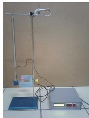
Gambar 14. Hasil desain set eksperimen gerak harmonis sederhana pada pegas untuk susunan pegas tunggal
